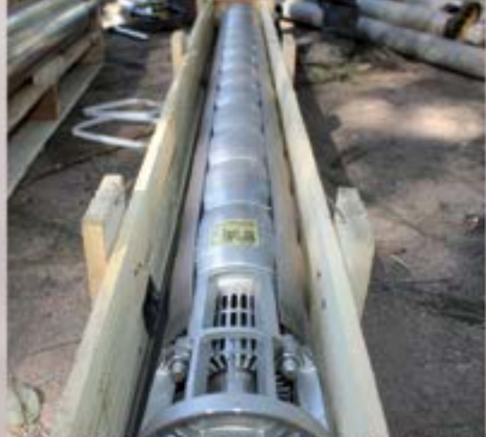
INSTALACION DE NUEVO MOTOR Y BOMBA EN EL POZO DEL OJO DE AGUA (40 CABALLOS DE FUERZA)
